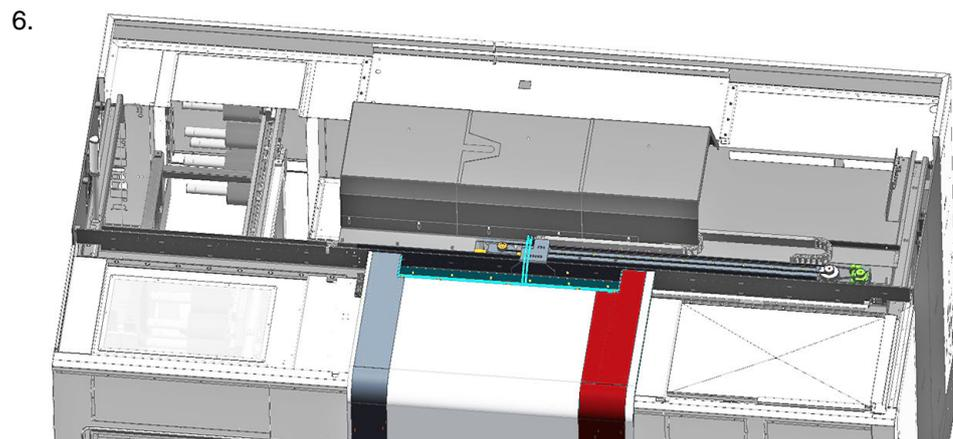
Beispiel: Ansicht der automatischen Arbeitsraumtür mit Antrieb
