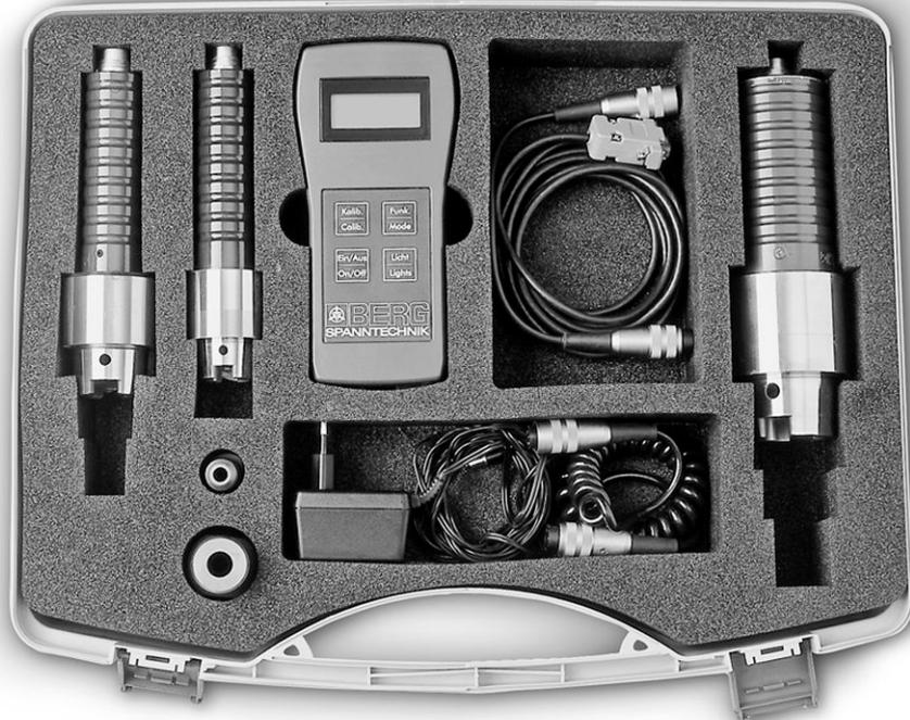
Beispiel: Spannkraftmesssystem Fa. Berg
