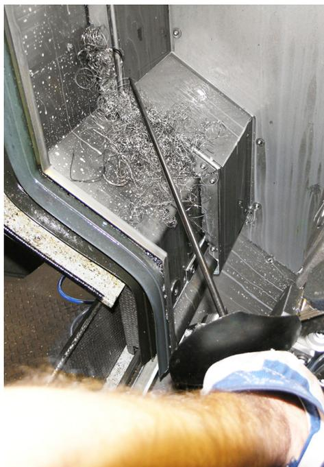
Beispiel: Entfernen der Spänenester mit Hilfe geeigneter Werkzeuge (z.B. Spänehook)
